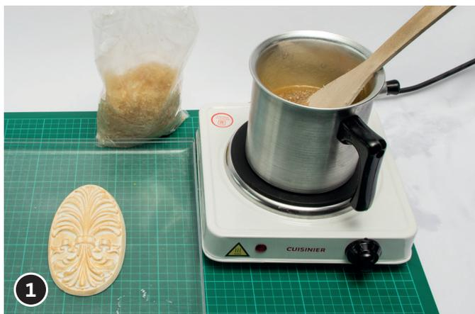
1 Une masse pour fabriquer des moules avec des possibilités d'utilisation exceptionnelles : Formaform est composé de petits granulés caoutchouteux qui vont être réchauffés et fondus dans un pot au bain-marie, comme de la cire. On obtient alors une masse épaisse, qui va être mélangée au condensateur joint, le liquide Formaform : proportion de mélange liquide Formaform dans une proportion de 100 : 40.
